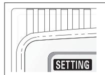
Sul pannello di comando dell'unità esterna compare il prompt SETTING lampeggiante. Questa indicazione scompare entro un tempo massimo di 4-5 minuti quando il pannello ha effettuato correttamente la comunicazione con l'unità esterna.
