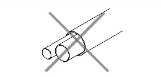
Nel caso non si utilizzino tubazioni preisolante, inserire i tubi nell'isolante che deve avere le seguenti caratteristiche:
